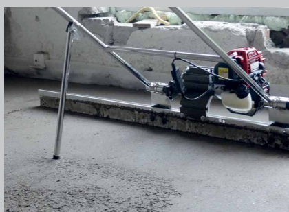
De uitklapbare steunpoot zorgt ervoor dat de FloorBlaster op werkhogte kan worden weggezet op het moment dat er even niet met de trilrei gewerkt wordt.
