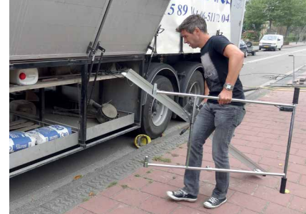
Indien nodig kan het frame met twee pennen losgekoppeld worden. Zo is de FloorBlaster eenvoudig te transporteren en op te bergen.
